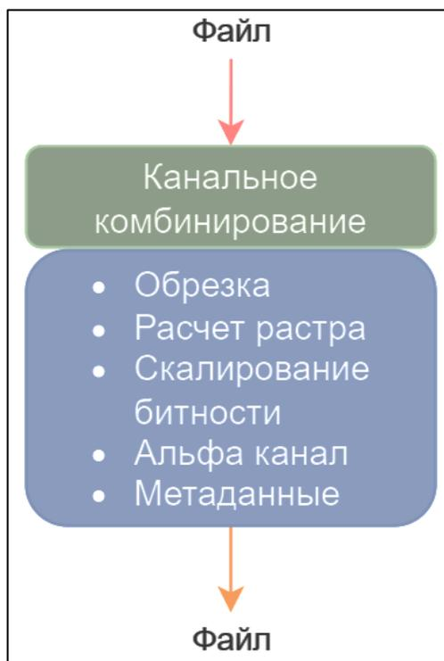
Рис. 96 – Схема ноды «Канальное комбинирование»
